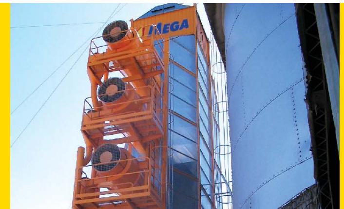
Это приспособление позволяет снизить уровень шума, произведенный низкозвучными турбинами, к более низкому уровню.
